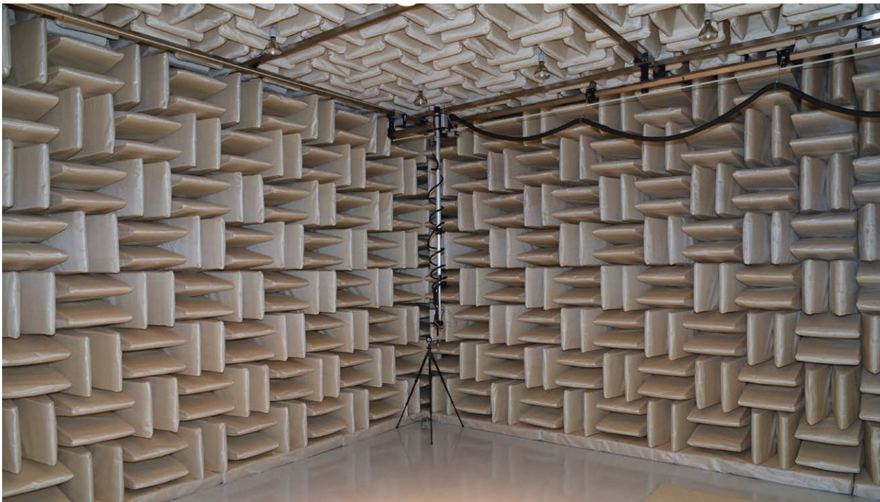
AERMEC Akustiktest im werkseigenen Akustiklabor
