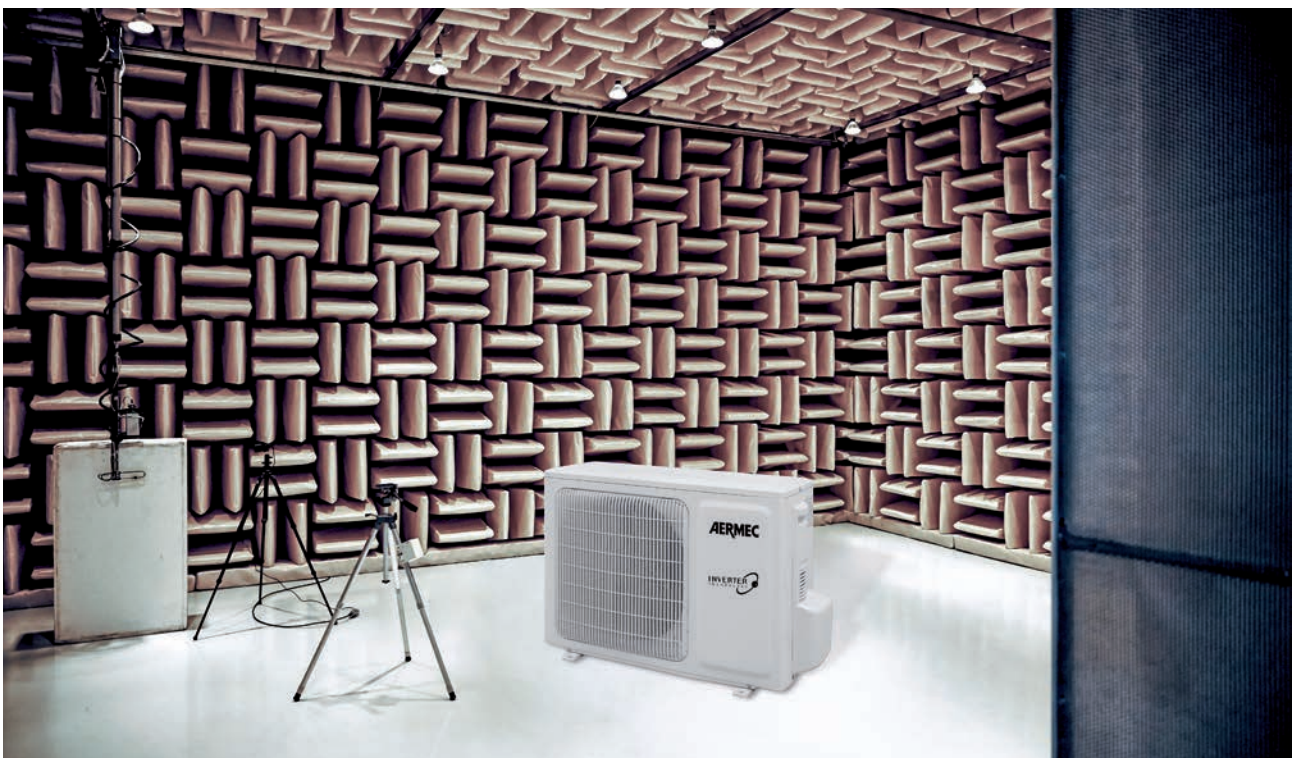
AERMEC Akustiktest im werkseigenen Akustiklabor
